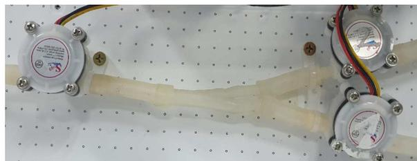
Рис. 2. Участок стенда: расходомеры и пластиковая модель артерии
