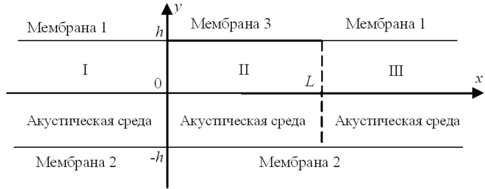
Рис. 1. Плоский акустический слой с кусочно-неоднородной стенкой
